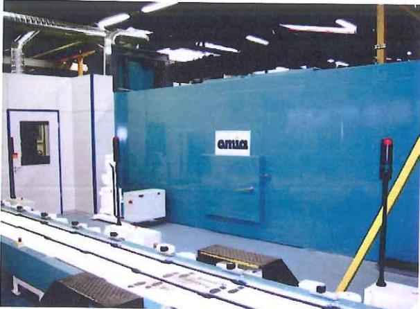
Tunnel de polymérisation avec convoyeur à plateaux
